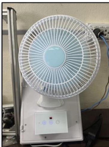
ภาพที่ 3.2 การติดตั้ง Tuya Wi-Fi Fan Switch เชื่อมต่อพัดลม
