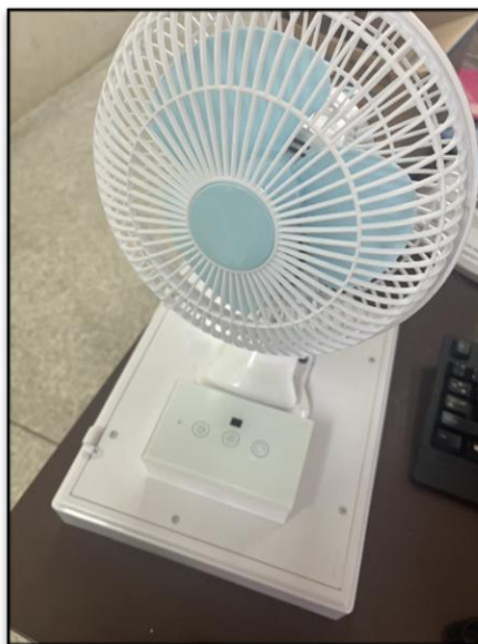
ภาพที่ 2.1 ระบบเปิด - ปิดพัดลมผ่านมือถือ
