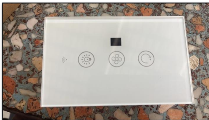
ภาพที่ 3.1 Tuya Wi-Fi Fan Switch
