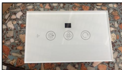
ภาพที่ 2.2 Tuya Wi-Fi Fan Switch
