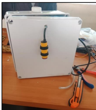
ภาพที่ 3.1 กล่องพลาสติกอเนกประสงค์ สำหรับงานอิเล็กทรอนิกส์ จากภาพที่ 3.1 ทำการวัดและเจาะรูที่ตัวกล่องพลาสติกอเนกประสงค์ สำหรับงานอิเล็กทรอนิกส์
